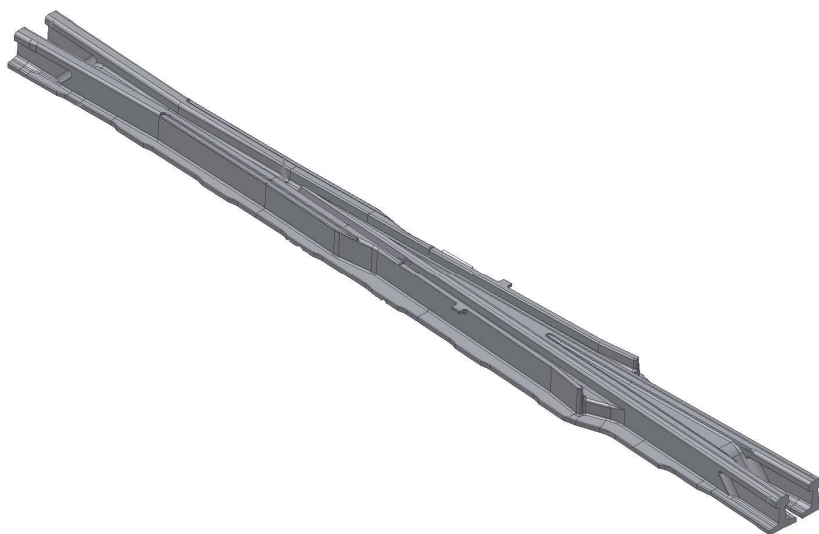
Odlitek Mn srdcovky 60E1 1:12-500 z programu Inventor (cca 5 230x320x175mm)
