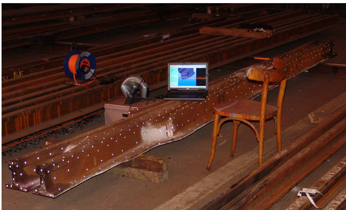
Odlitek Mn srdcovky 60E1 1:12-500 (kov, 420min., 740 bodů)
