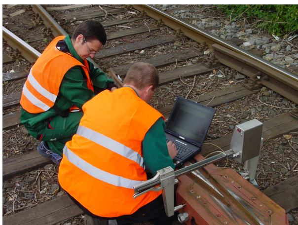
Snímání ojetí srdcovkovým profiloměrem
